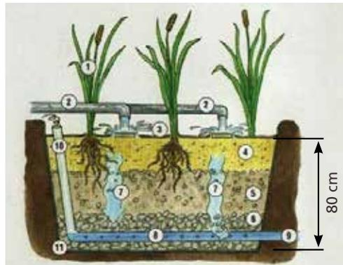
**Filtre planté de roseaux à écoulement vertical [FPRV] en coupe transversale**
